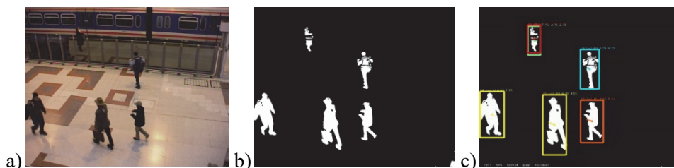
Rys. 1. Proces detekcji i śledzenia obiektów: a) klatka oryginalna, b) maski wykrytych obiektów, c) wyznaczone obwiednie po filtracji Kalmana
